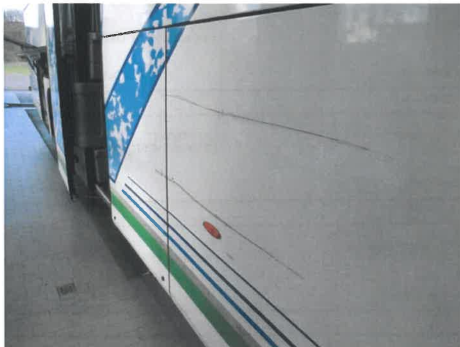
Bild 18 : Seitenklappen rechts eingedrückt/verschrammt
