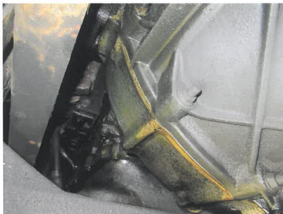
Bild 38 : Motor und Getriebe Ölverlust
