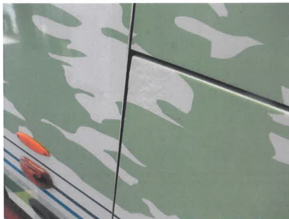
Bild 30 : Seitenklappen teilweise instandgesetzt
