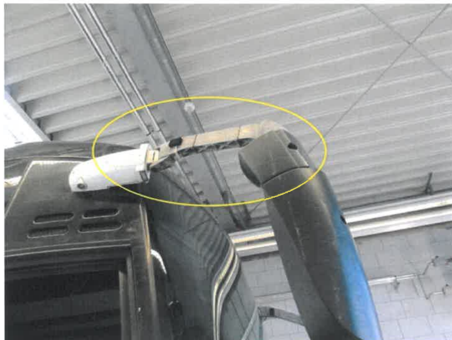
Bild 46 : Blenden Spiegelarme fehlen
