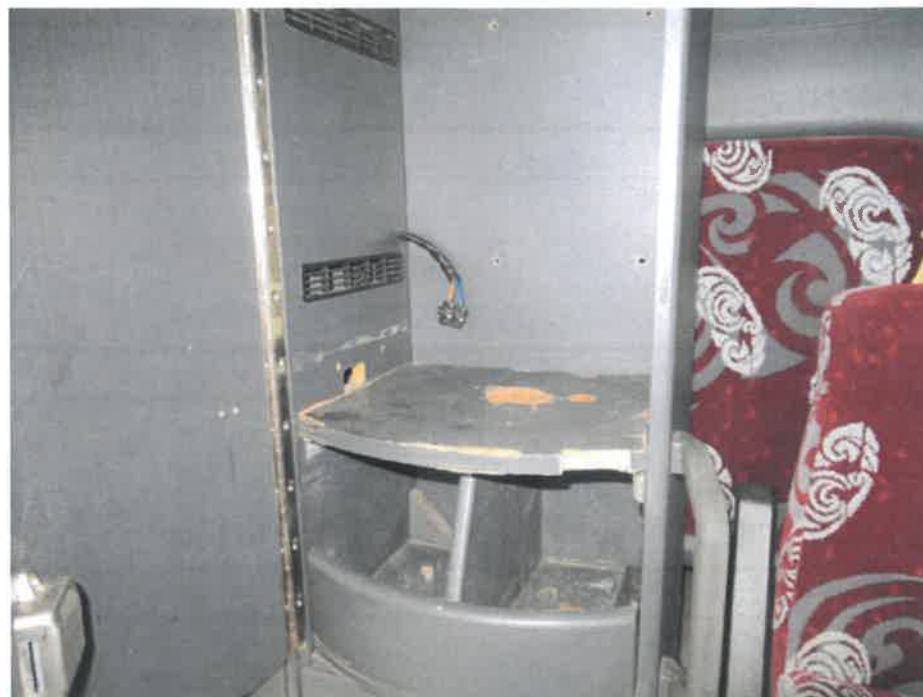
Bild 13 : Einbauschränk vorne rechts aufgerissen, Kaffeemaschine fehlt
