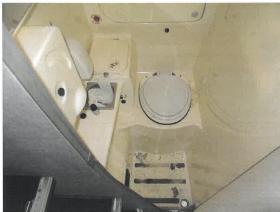
Bild 16 : Toilette stark verschmutzt/Unterboden deformiert
