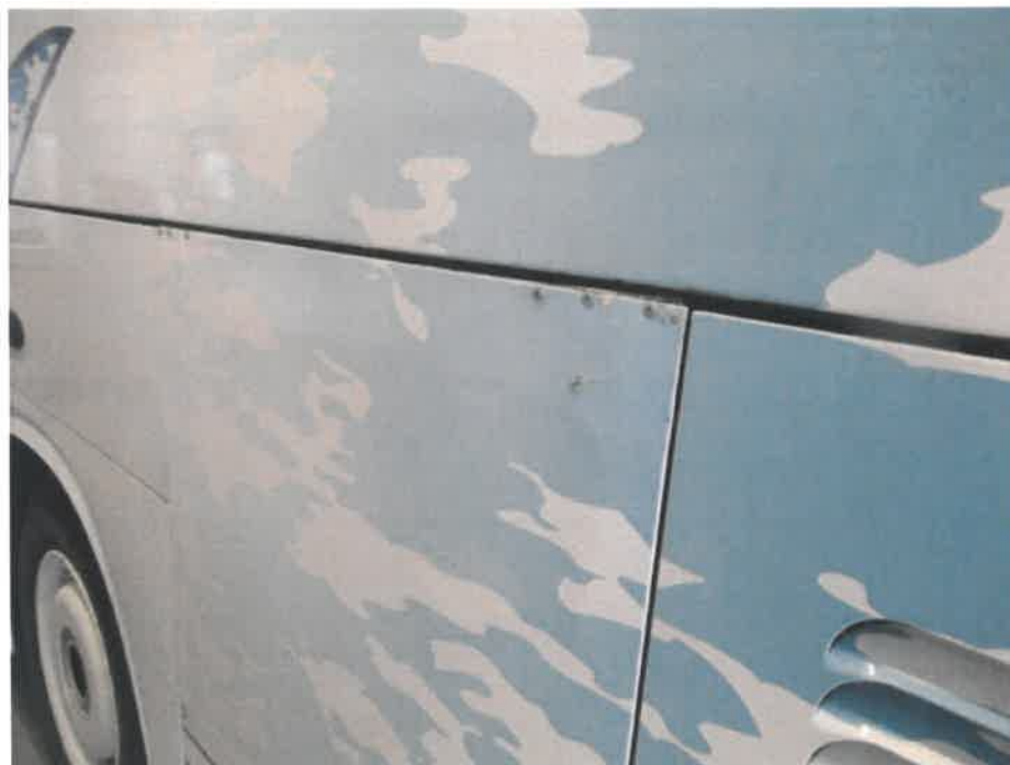
Bild 29 : Seitenklappe hinten links und Radlauf hinten links deformiert
