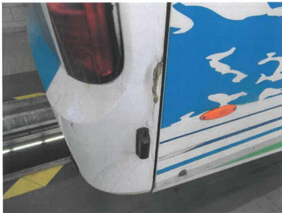
Bild 23 : Ecksäule hinten rechts aufgerissen
