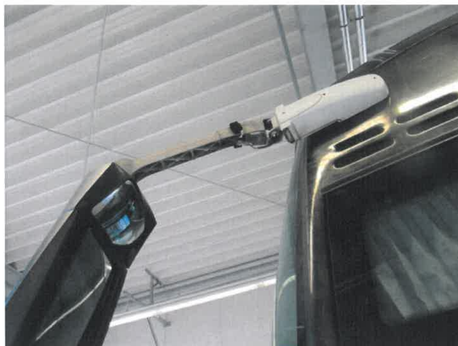
Bild 44 : Blenden Spiegelarme fehlen
