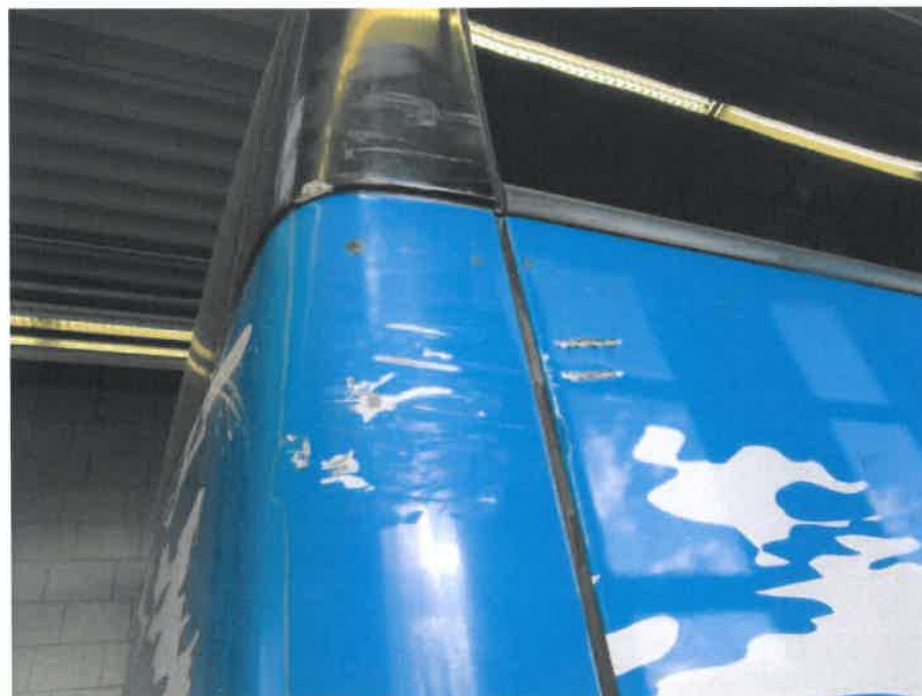
Bild 24 : Ecksäule hinten rechts aufgerissen
