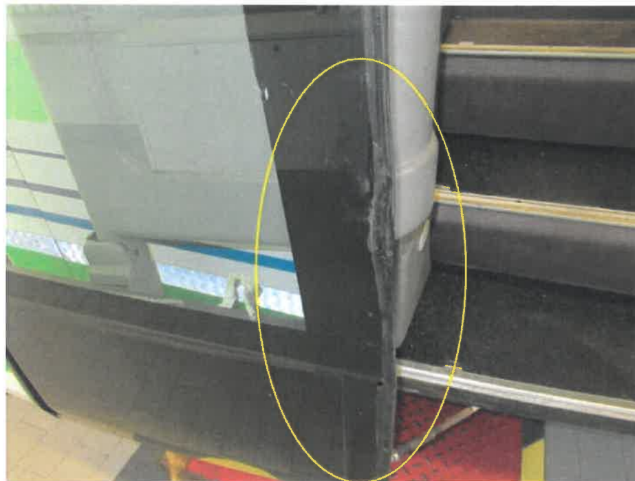
Bild 47 : Tür vorne rechts deformiert
