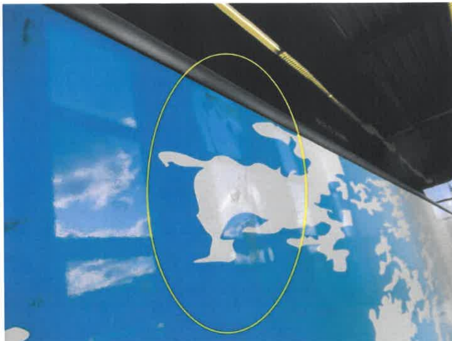
Bild 25 : Seitenwand rechts oben hinten eingedrückt
