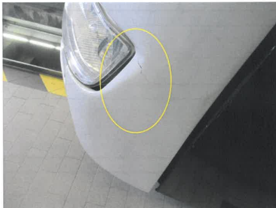
Bild 10 : nicht fachgerecht instandgesetzter Unfallschaden vorne links
