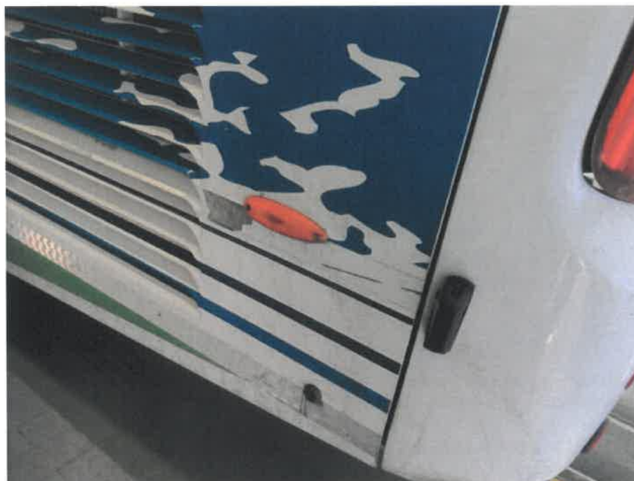
Bild 28 : Seitenklappe hinten links verschrammt
