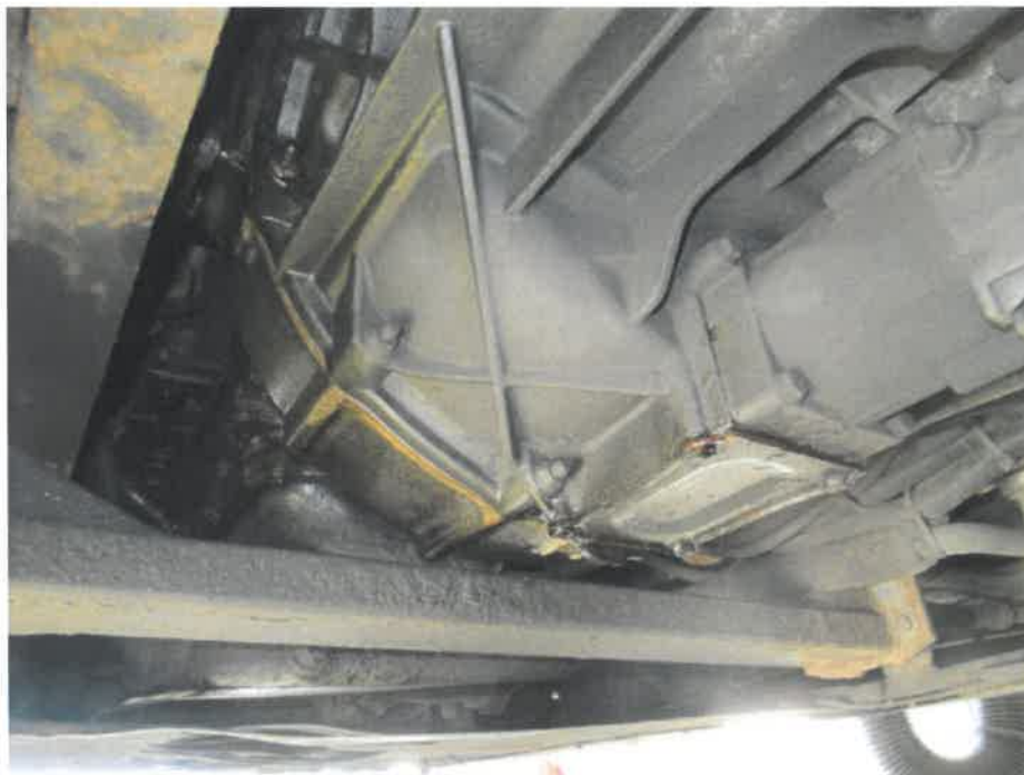
Bild 37 : Motor und Getriebe Ölverlust
