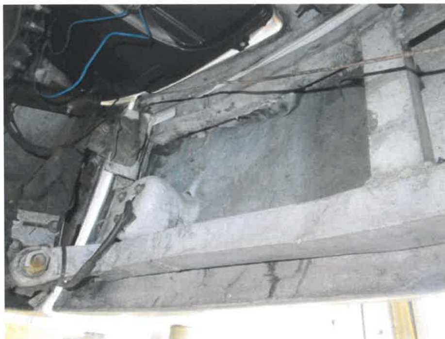
Bild 32 : nicht fachgerecht instandgesetzter Unfallschaden vorne links
