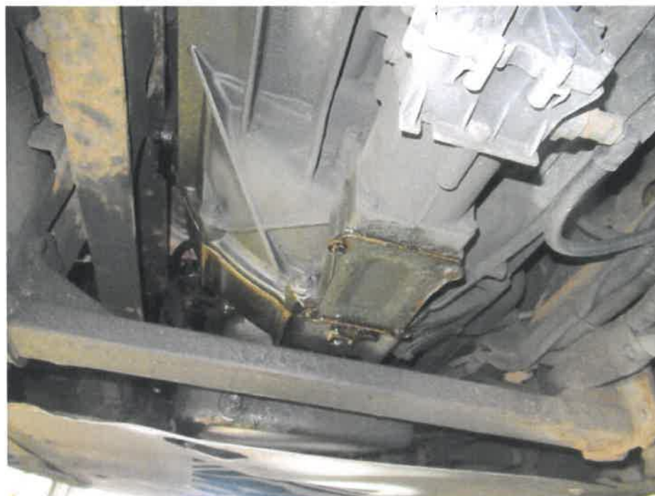
Bild 36 : Motor und Getriebe Ölverlust
