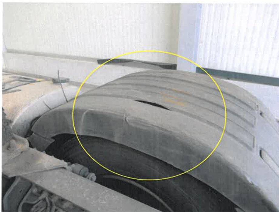
Bild 14 : Radabdeckungen HR gebrochen
