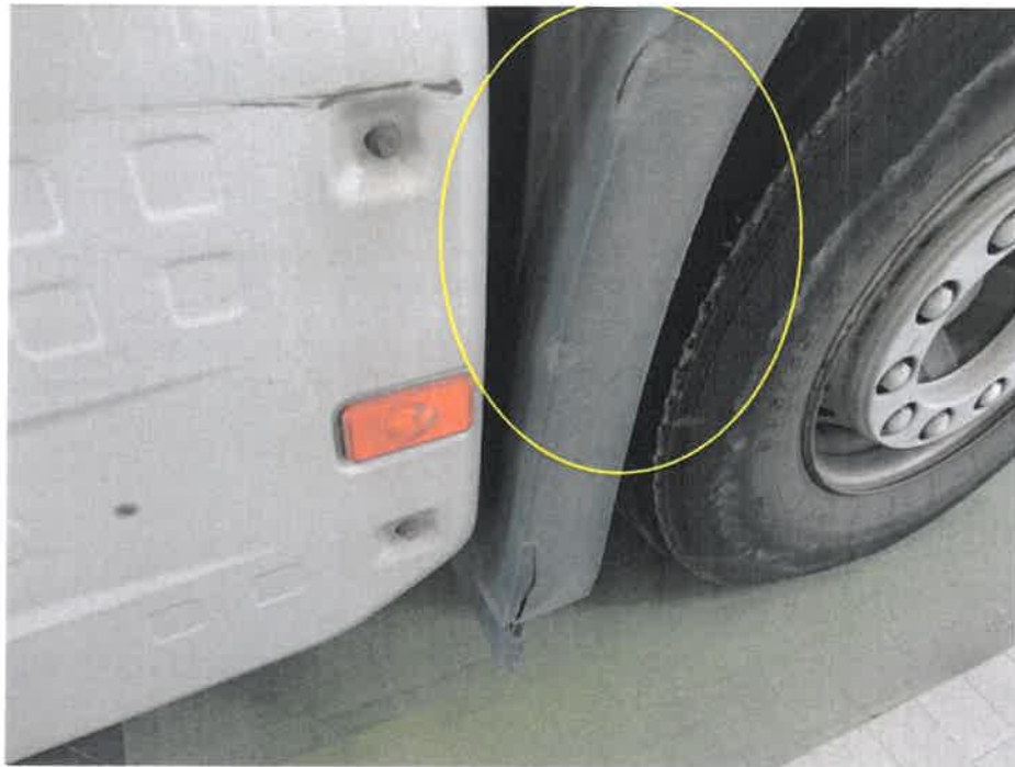
Bild 19 : Kotflügel VR 2x gebrochen
