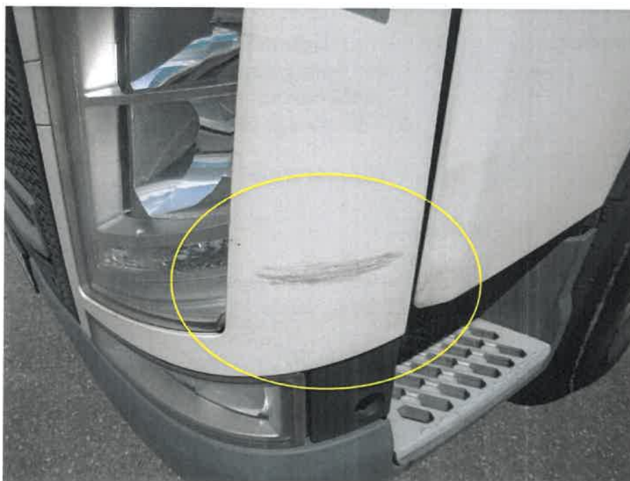
Bild 4 : Streifschaden VL: Stoßfängerecke, Türverlängerung, Kotflügel VL 2x, Seitendeckel HL 2x
