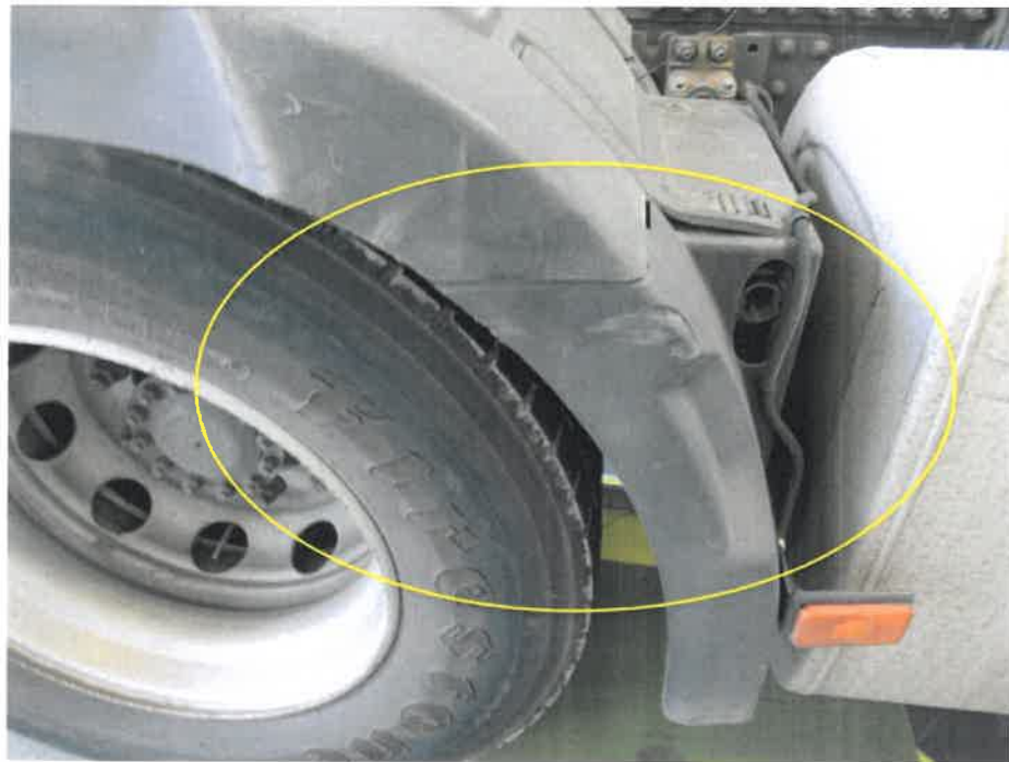
Bild 17 : Kotflügel HR deformiert
