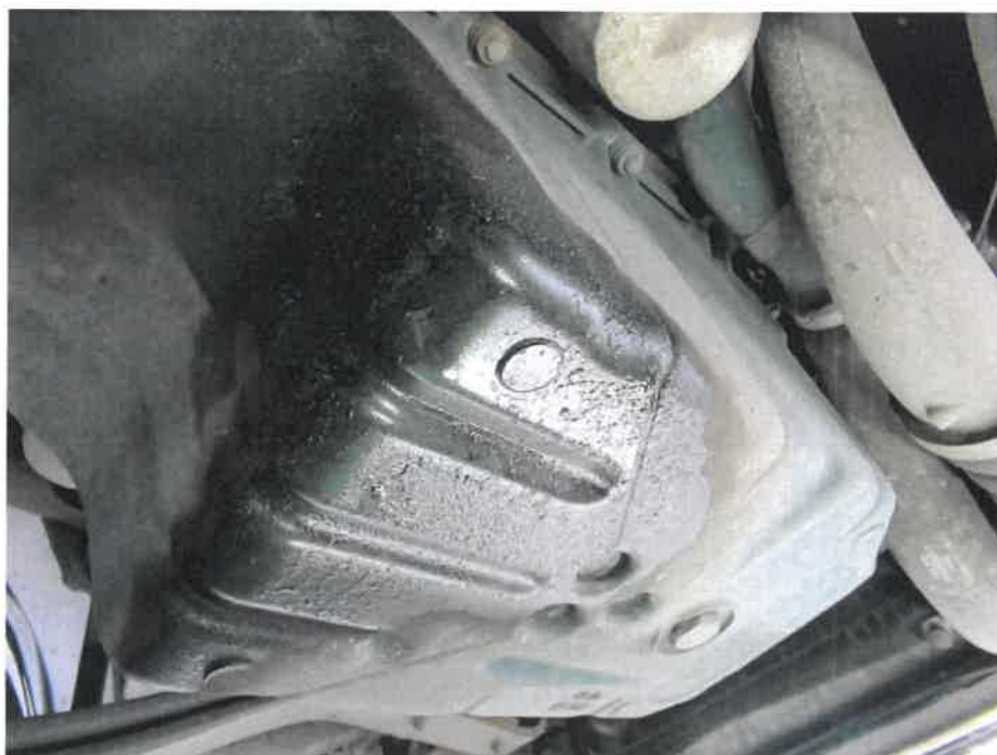
Bild 16 : Ölwanne Motor undicht
