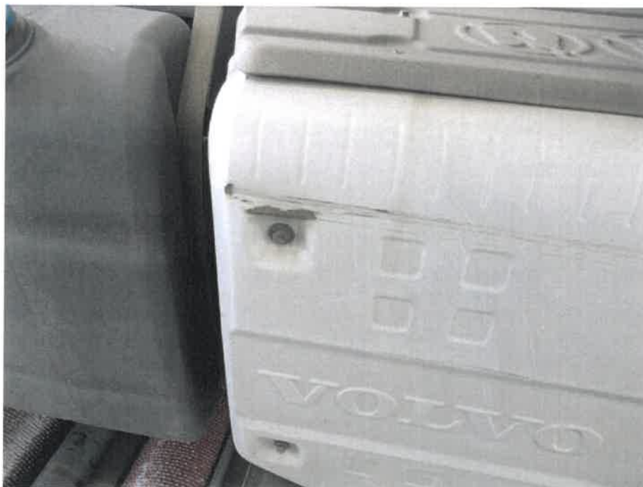
Bild 20 : Abdeckung Endschalldämpfer deformiert
